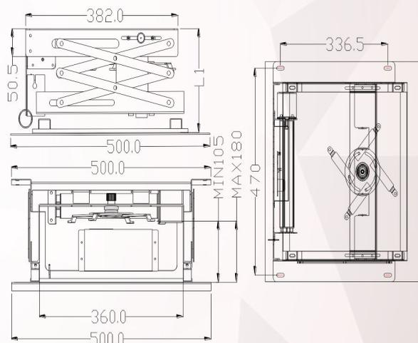
Min. Tamaño de Elevación (Plegado): 500 x 500 x 190 mm
